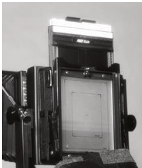
Internationales Rückteil mit halb gezogener Filmkassette
